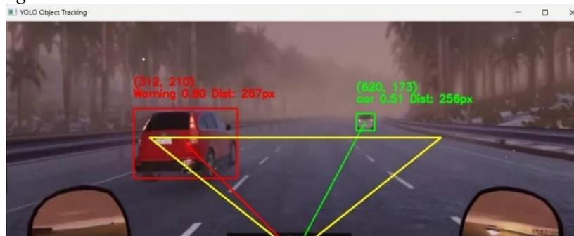
**Nota:** La captura de video que sirvió como prueba controlada de tráfico tomado del software de simulación (APEX Simulación y Tecnología, 2020)
